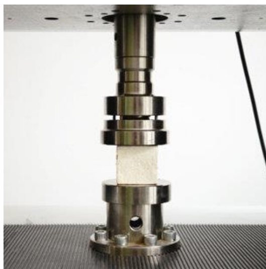
Figura 35: ladrillo de micelio constituido por la especie Trametes Versicolor en un ensayo a compresión [35]
