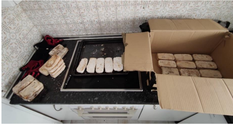
Figura 72: las probetas fueron guardadas en una caja hasta el día del ensayo a compresión en el laboratorio
