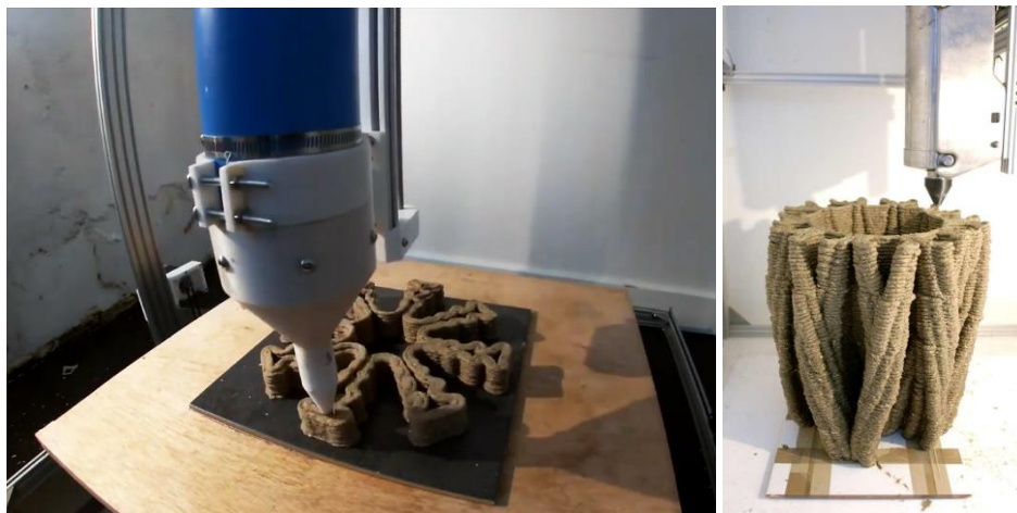
Figura 40: Impresión 3D con filamentos de cartón reciclado
