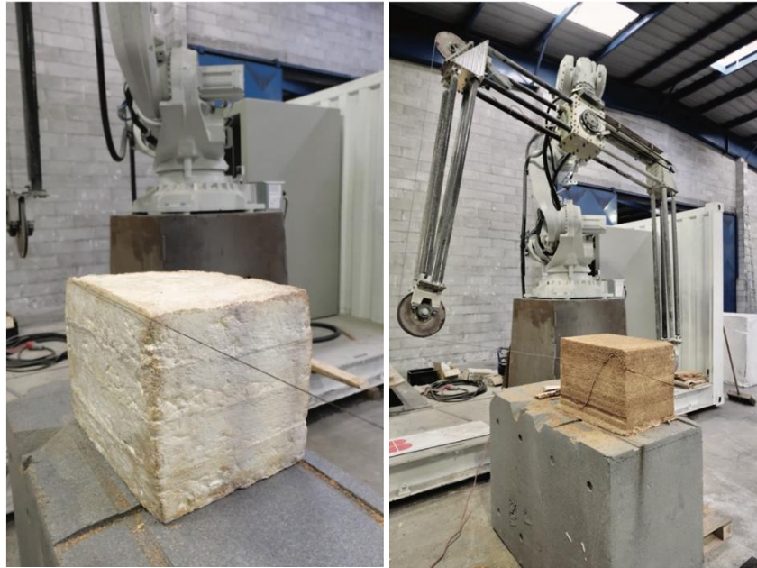
Figura 38: a) Bloque preforma antes de ser cortado por hilo caliente b) Bloque después de la operación de corte por hilo caliente [38]
