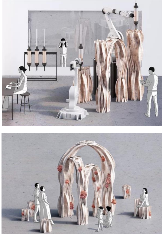
Figura 39: Proceso de impresión 3D con micelio de Blast Studio
