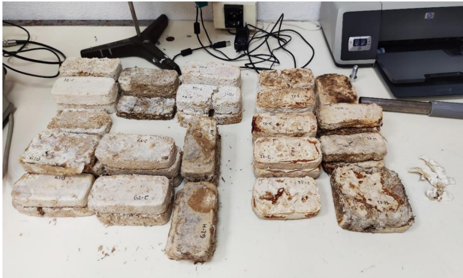
Figura 76: Probetas a ensayar. Composites de micelio formados por las especies T.Versicolor , G.Lucidum , P.Ostreatus y sustratos de heno, cáñamo y serrín
