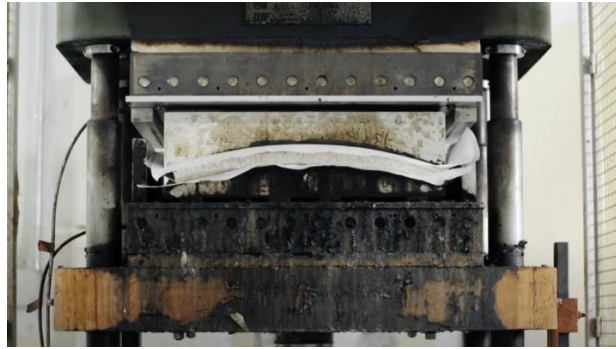
Figura 31: Panel de micelio en la etapa de cocción y compresión (Autoclave)
