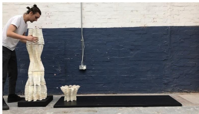
Figura 43: Ensamblaje de piezas impresas en 3D para formar una columna de micelio
