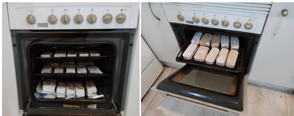
Figura 71: Horneado de las probetas a 80°C durante 3 horas
