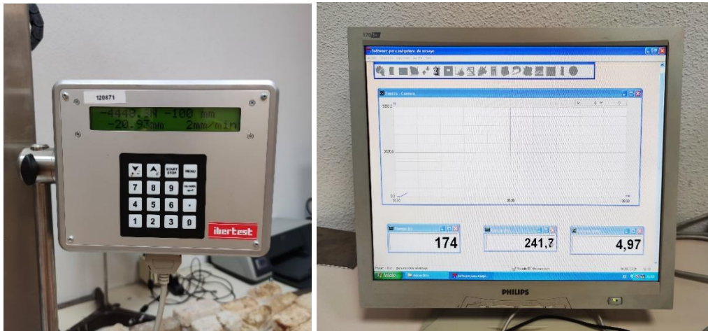
Figura 75: Visualización de los datos a) Pantalla móvil de la máquina b) Registro de datos en el Software de ordenador
